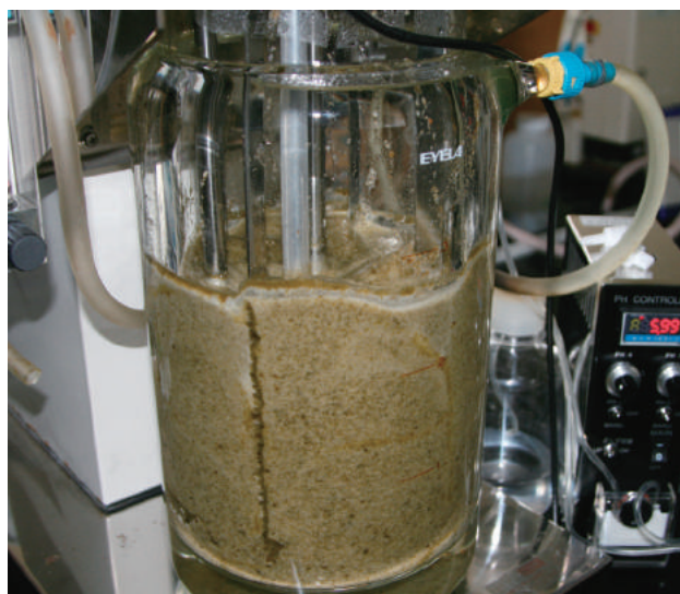
■海藻を原料としたバイオマス燃料生成。海洋細菌(マリンビブリオ)をジャーファーメンター装置を用いて培養し、バイオエタノールと水素の同時生成条件を検討している。
